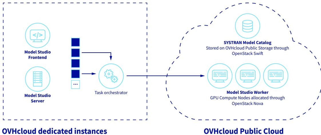
Cette infrastructure a été mise au point en un an. Durant cette période, les équipes de SYSTRAN ont pu entraîner des centaines de modèles en utilisant un pool basé sur des serveurs NVIDIA DGX-1, ainsi que des pools complémentaires de Public Cloud s'appuyant sur des instances GPU NVIDIA Tesla V100. La plateforme est maintenant à la disposition des « entraîneurs » de la marketplace, pour leur permettre de créer leurs propres modèles en toute autonomie.
